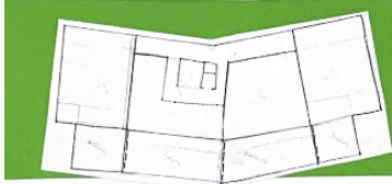
it Hilfe des Grundrisses des 2. OGs Außenwände und dann innere Abteilung und Balkone bestimmen bzw. festlegen.
